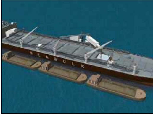
Figur 5-5: Tradisjonell tørrbulklastning fra lekter
