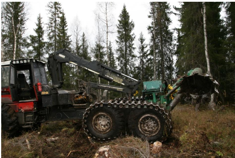
Lassbærermontert markberedningsutstyr. Foto: Berit Sanness
