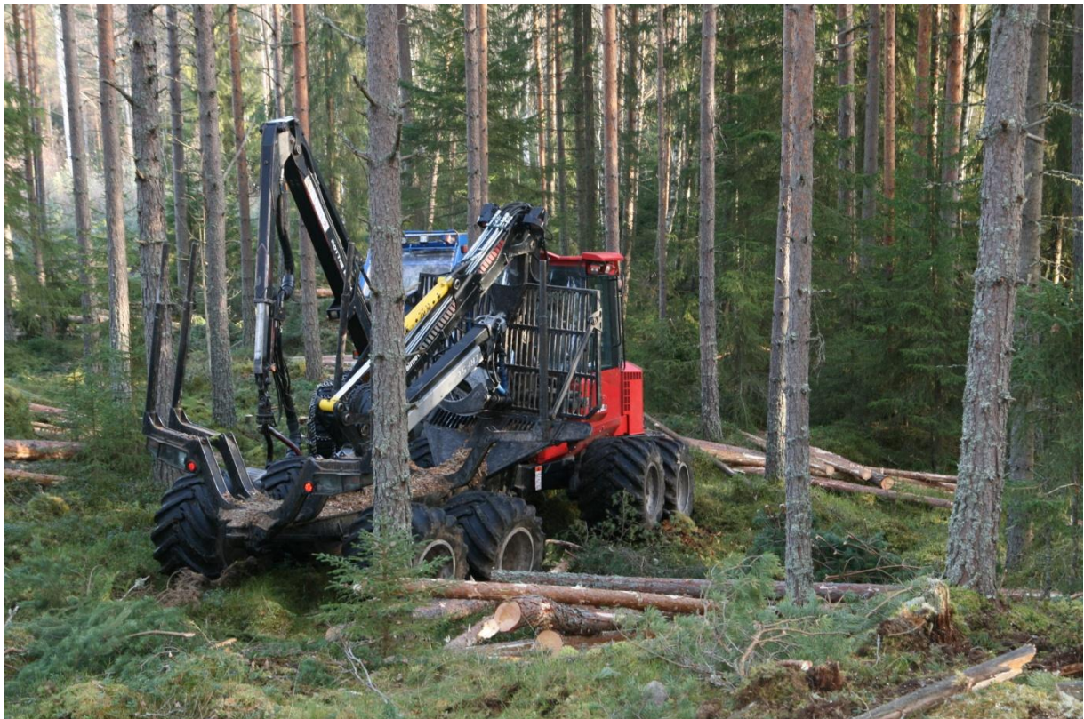
Tynningsmaskinene er middels store til små og utstyrt med hjulrustning og belter for å begrense marktrykk og skåne bakken mest mulig. Foto: Berit Sanness
