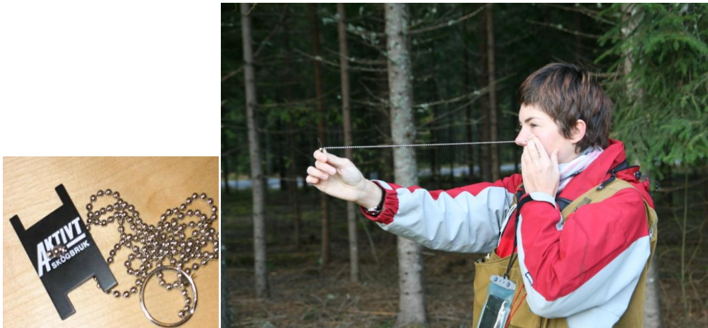
Bildet til venstre viser et relaskop. På bildet til høyre benytter skogbruksplanlegger Jennie Sverker relaskopet. Hun teller antall trær som fyller spalten i en sirkel der hun står i sentrum. Ved å gange antall trær med 2, finner hun grunnflatesummen på stedet. Foto: t.v. Skogbrukets Kursinstitutt, t.h. Berit Sanness
