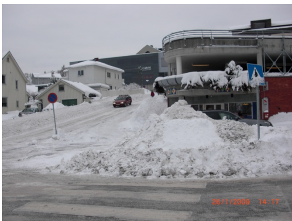
Figur: Eksempel på dårlig plassering av snøopplag
