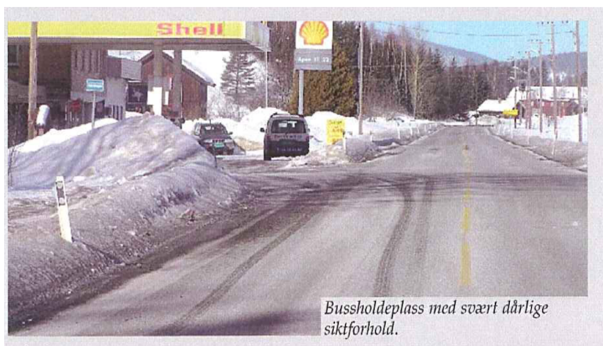
Figur: Manglende prioritering av bussholdeplass ved brøyting
