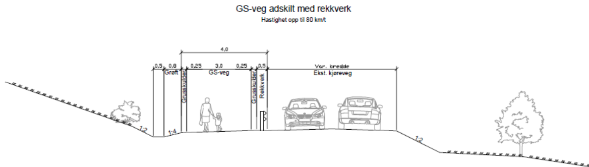
Figur 22 Normalprofil for gang- og sykkelveg med rekkverk
