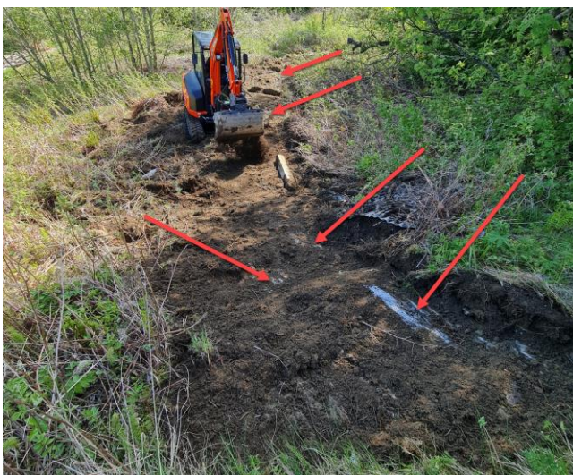
> Figur 4: Bildene presenterer trenden av løsmassemekthet på eiendommen, antatt berg er markert med røde piler. Bildet til venstre er fra B6 til B8 og bildet til høyre er fra PG1.
