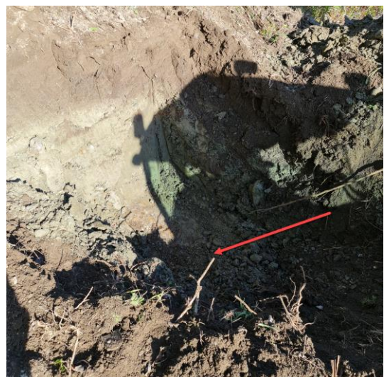
> Figur 4: Bildene presenterer trenden av løsmassemekthet på eiendommen, antatt berg er markert med røde piler. Bildet til venstre er fra B6 til B8 og bildet til høyre er fra PG1.
