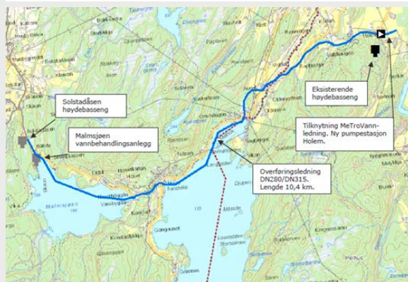
Figur 28. Ledningsstrase MeTroVann-ledning ved Holem til vannbehandlingsanlegg ved Malmssjøen.
