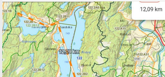
Figur 28. Ledningsstrase MeTroVann-ledning ved Holem til vannbehandlingsanlegg ved Malmssjøen.
