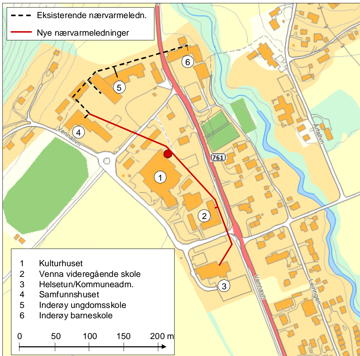
Figur 1. Kart over området med fjernvarmetrasé og aktuell bygningsmasse inntegnet
