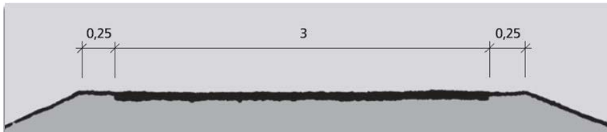
Figur 5 Tverrprofil for gang- og sykkelveg
