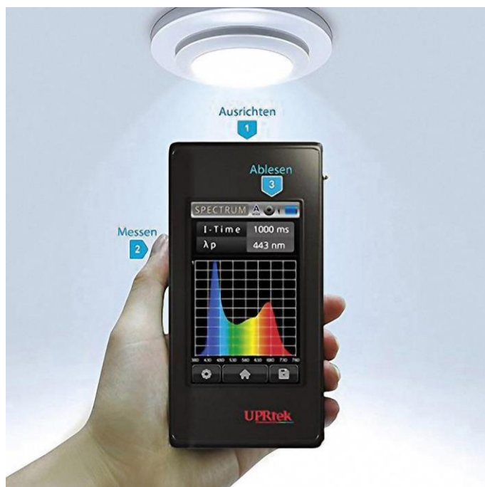
Fig. 3: Bildet viser instrumentet som ble brukt i prosjektet. UPRtek MK350N Premium Handheld Spectrometer.
