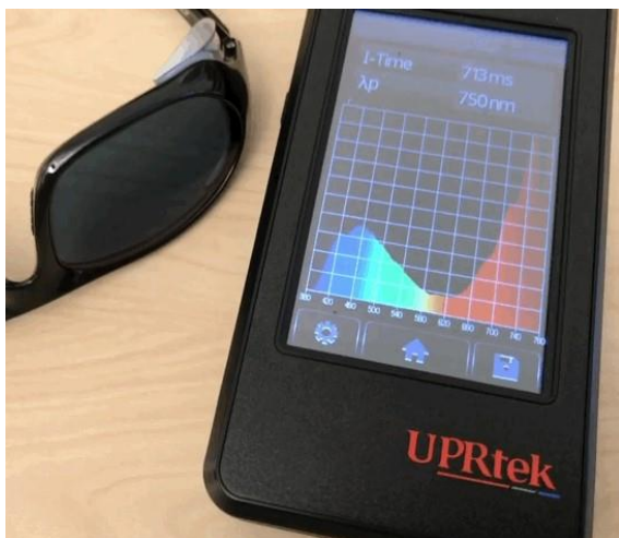
Fig 8. Bildet viser hvordan ulike bølgelengder av lyset går gjennom det filterglasset som denne brukeren foretrekker. Kurven viser at filterglasset slipper gjennom en del av det blå lyset, selv om det er redusert med 65%. Filteret stopper mye av «gule lyset» som har bølgelengder rundt 500 - 600nm. Det er dette lyset som brukeren opplever som blendende. Men dette glasset reduserer dette lyset med 90%.
