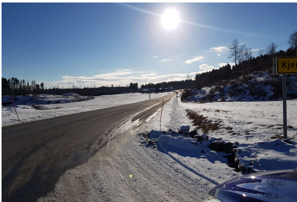
Figur 5: Bilde tatt i avkjøringa mot Kjerkesvågen på Tømte. Her starter gang- og sykkelvegen og går på høyre side av kjørevegen, først over dyrkamark før den treffer fjellknaus/ berg i dagen. Dette vil innebære det største terrenngrepet på strekningen.
