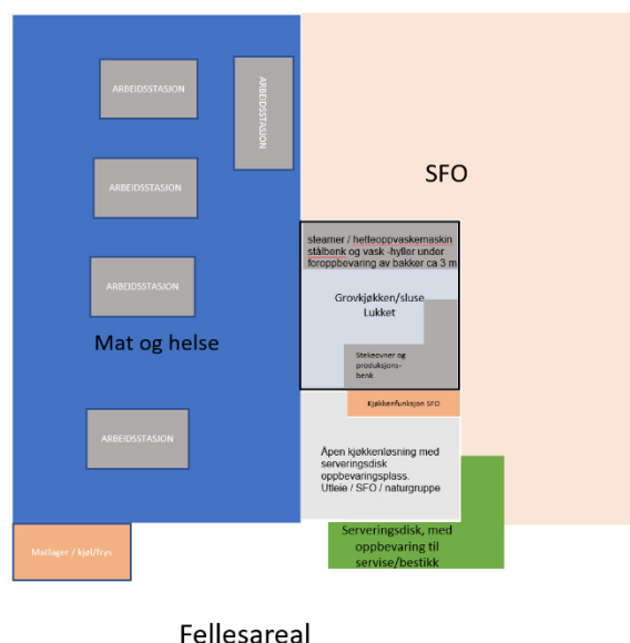
Figur 2 Prinsippsskisse for felleskjøkkenet
