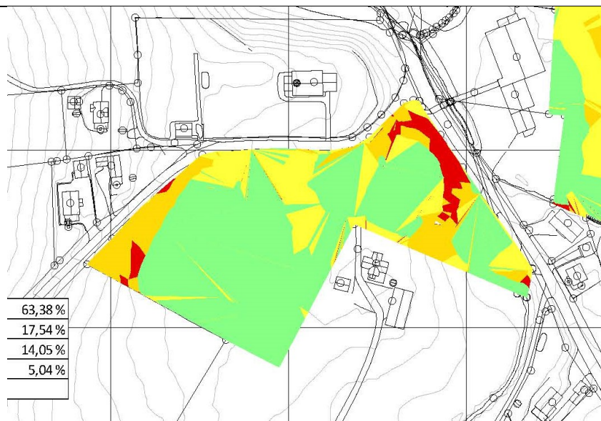
Fig. 4. Helningskartet over tomt 1 (grønt betyr under 5% helning, gul mellom 5 til 10%, oransje mellom 10 til 20% og rød utover det).
