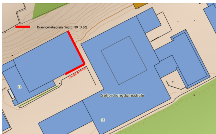
Figur 1 plassering av nabobygg og eventuelle skillekonstruksjoner
