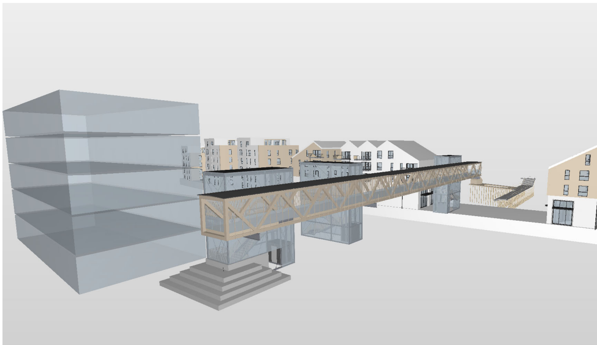
Figur 7-2 Bru over jernbane - utsnitt fra IFC modell (sett fra Jernbanetorget i sør-øst)
