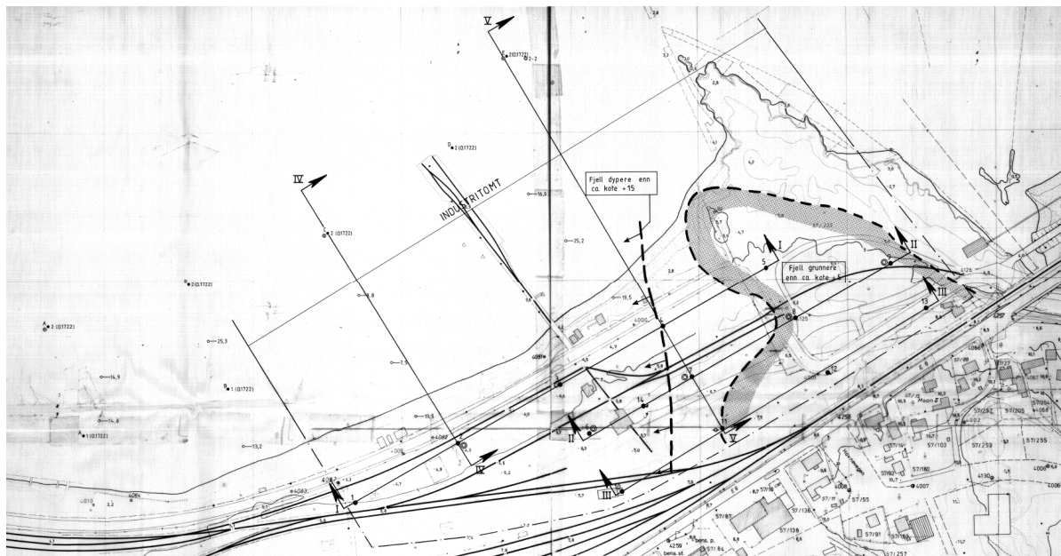
Figur 7 Situasjonsplan med utførte grunnundersøkelser i området (utsnitt fra tegning nr. 2 fra rapport nr. o.6354 [4] datert 16. mars 1987)
