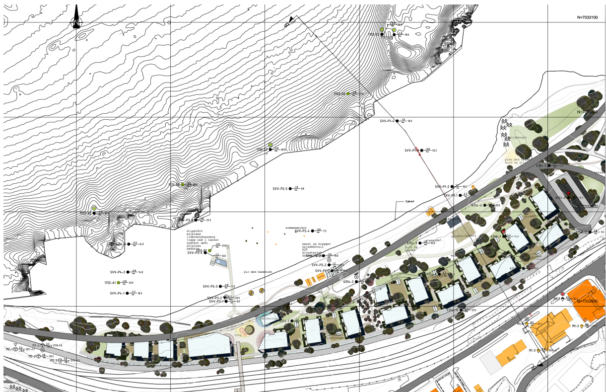
Figur 7 Situasjonsplan med relevante grunnundersøkelser. Borpunkter med påvist sprøbruddmateriale/kvikkleire er markert med rød sirkel.
