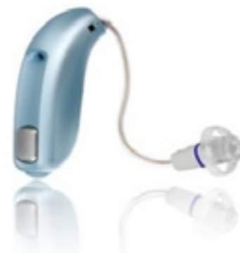
Figur 4. Her et høreapparat med åpen propp som slipper lyden inn til trommehinnen på vanlig måte. Kilde: Oticon
