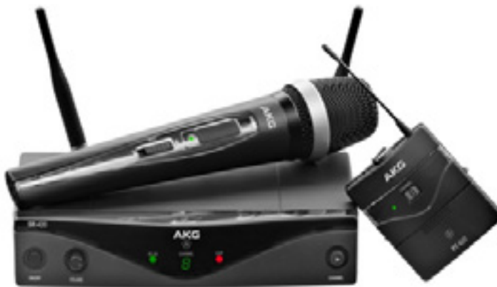
Figur 41. Her et trådløst utstyr fra AKG med en 2 kanals mottaker, en håndholdt mikrofon og en lommesender. Det viste produktet er AKG WMS 420. Denne standardpakken leveres med en dynamisk mikrofon i den håndholdte enheten, så det går IKKE bra sammen med teleslynge som nevnt tidligere.
