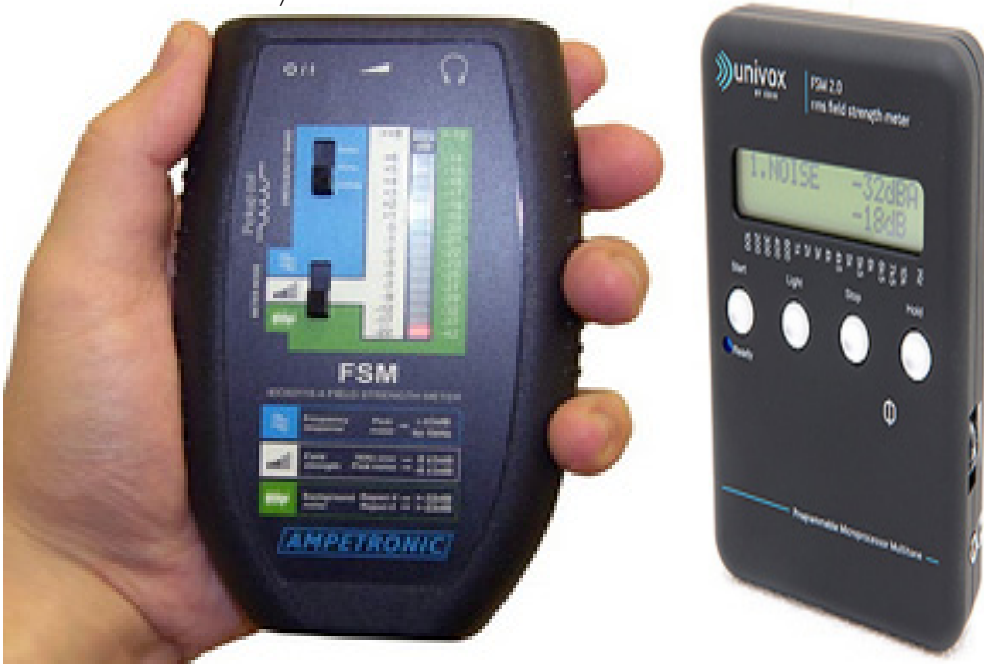
Figur 27. Her ser vi 2 feltstyrkemålere for sertifisering av teleslynger. Til venstre Ampetronic FSM og til høyre Univox FSM 2. Det er viktig at instrumentene må holdes vertikalt og i riktig høyde ved målinger.
