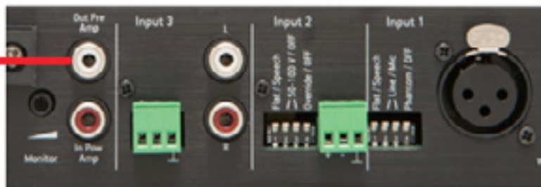
Figur 54. Her ser vi litt mer av bakvegen på teleslyngeforsterkeren PLS-XI, med pluggen merket "Out Pre Amp". Denne koples til den aktive høyttaleren. Denne utgangen sender ut et linjesignal tilsvarende det som går til teleslyngen.
