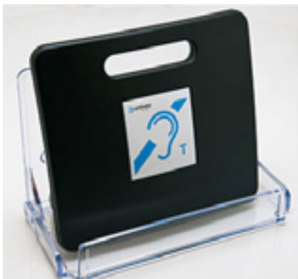
Figur 66. Univox P-CTC er en portabel teleslyngeløsning som dekker området ca 1,2 meter foran enheten, har innebygget oppladbart batteri for 4 timers drift. På bildet er den vist med en tilpasset hylle.
