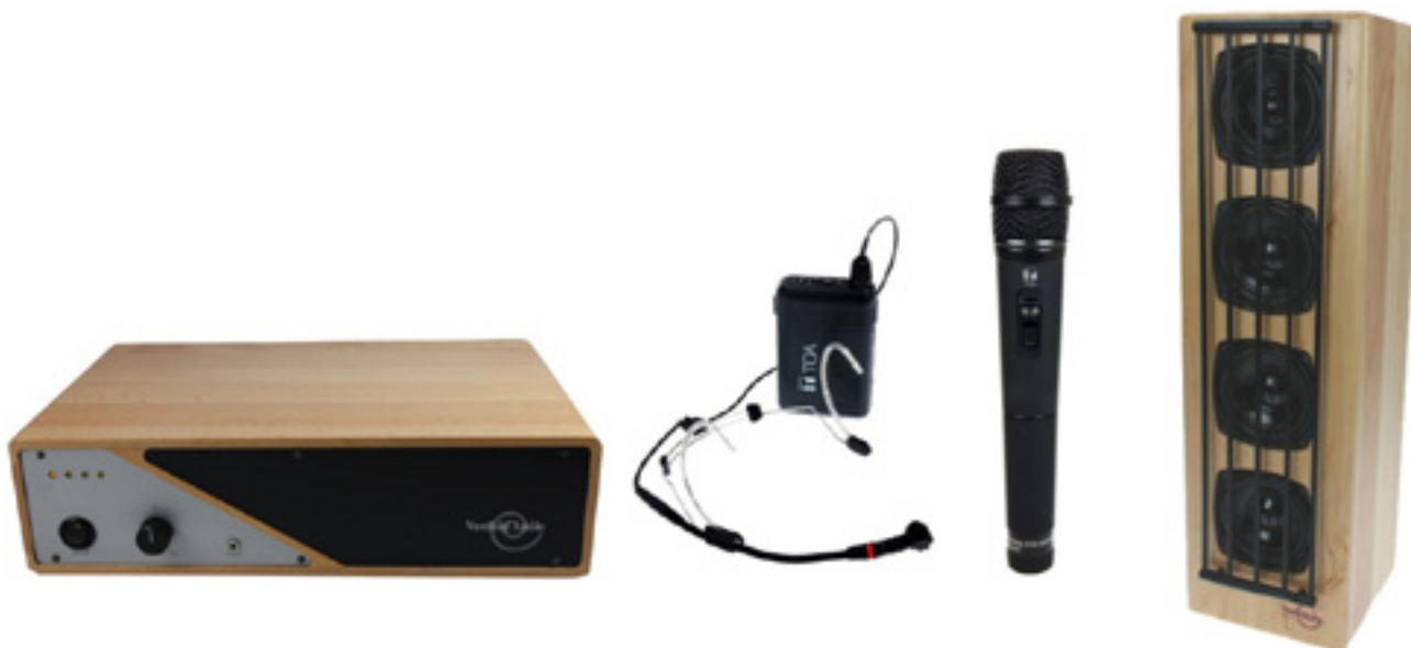
Figur 58. Her ses hovedkomponentene i Audiolink-anlegget - fra venstre; basestasjon, trådløs mikrofon med hodebøylemikrofon, trådløs håndholdt mikrofon og høyttaler. Basestasjonen inneholder trådløse mottakere, forsterker for høyttalerne og mikser signalene fra de forskjellige inngangene og gir konstant signalstyrke til teleslyngeforsterkeren.
