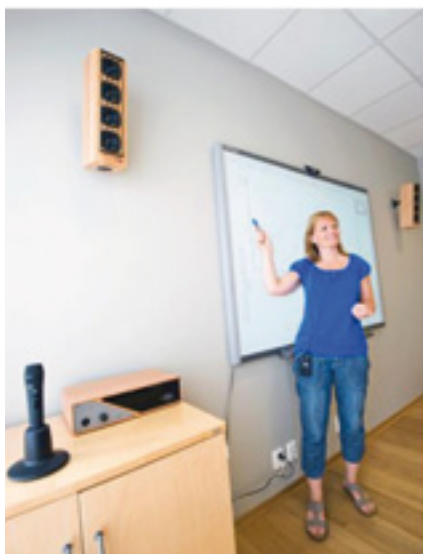
Figur 6. Audiolink baseenhet sammen med 2 søylehøytalere for jevn lydforde-ling i rommet. Kilde: Vestfold Audio a.s.
